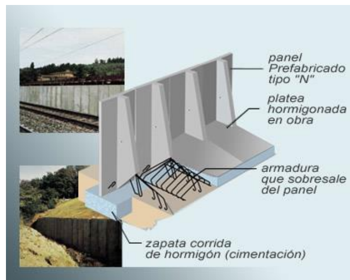
Infografía V-3 Panel Prefabricado tipo N. (@Mundo_Hormigon, 2018)
