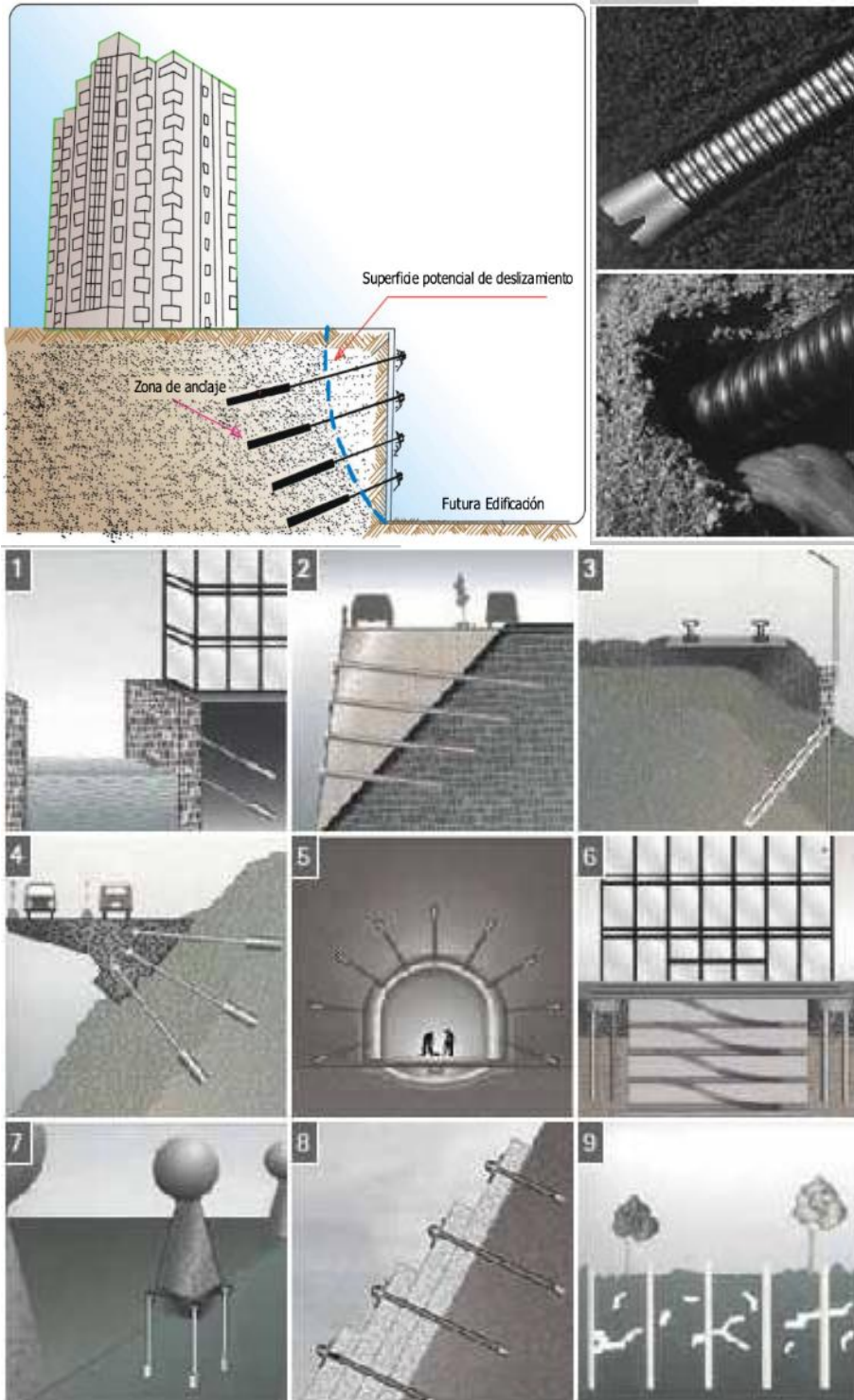
Infografía V-4 Superior derecha: Figura 1.3. Muro anclado construido en centro urbano (Ucar Navarro, 2002, pág. 10); superior izquierda: 2 anclas autopercutoras y números 1-9 al inferior aplicaciones anclas al terreno. Las primeras (Mexpresa, s.f.)
