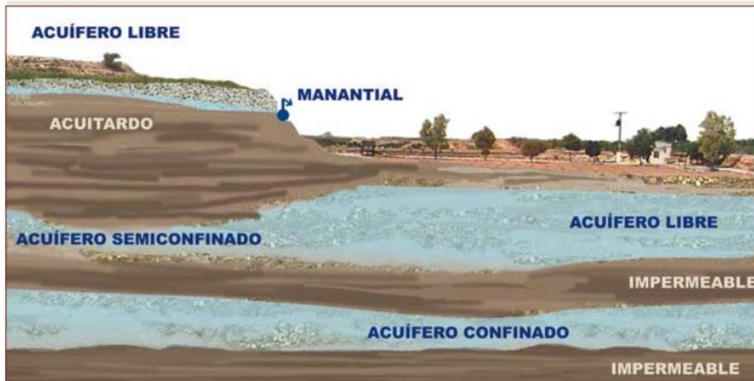
Ilustración I-4 Tipos de acuíferos en función de la presión hidrostática del agua contenida en ellos (López Geta, Fornés Azcoiti, Ramos González, & Villarroya Gil, 2009)
