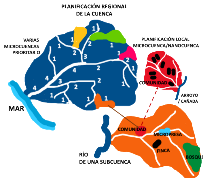
Ilustración V-2 Gestión integral de unidades territoriales de los recursos hídricos (cuenca exorreica) adaptada de figura 1 (Breña Puyol, Jacobo Villa, & Alarcón Lizardi, 2006, pág. 23) figura 12 (Josabeth, 2015), y su ordenación de una red de canales según Strahler
