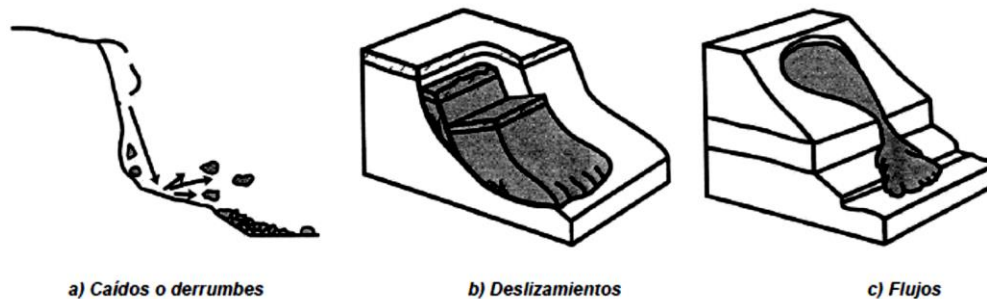
Fig. 5.1.4.1 Principales tipos de deslizamiento
